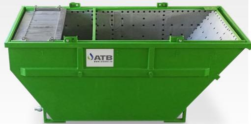
Entwässerungscontainer entwässern alle Arten von Schlämmen effektiv und preisgünstig. Die Innenseite der Container ist mit einer durchlässigen Doppelschicht aus säure- und basenbeständigem Gewebe ausgekleidet. Sammeln, Lagern, Entwässern und Transportieren – alles mit einem Gerät.
