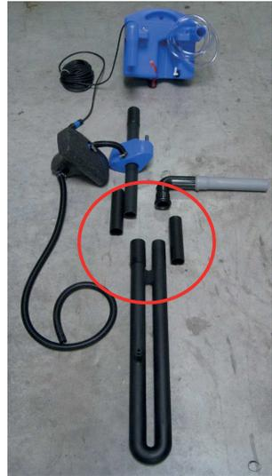
Setzen Sie den Rohrsatz wie auf der Abb. rechts dargestellt zusammen und fixieren Sie die Muffen mit den eingesetzten Schrauben.
