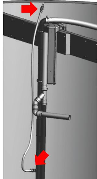
Wiederholen Sie den Vorgang mit den Drucklufthebern für den Klarwasserabzug und die Schlammrückführung am Hebersatz des Basispaketes, der anschließend in die Belebung gehängt wird.
