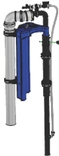
Der Luftheber für die Schlammrückführung muss bis zum Bodenbereich der Nachklärung (ca. 5 cm oberhalb des Bodens) verlängert werden.
