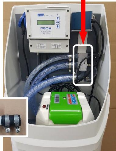
Montagebeispiel mit JDK-S-150/250 in ATB-Freiluftsäule und 25-mm Schlauch für die Belüftung.
