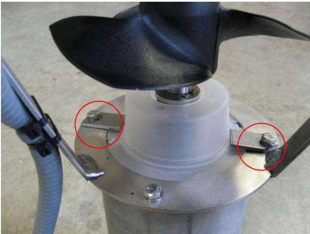
2. Innensechskantschraube mit dem Steckschlüssel lösen
