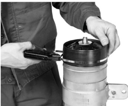
4) Propeller auf die Welle montieren
