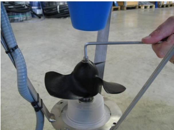
3. Welle mit Wasserpumpenzange festhalten und Propeller gegen den Uhrzeigersinn mit Handkraft lösen
