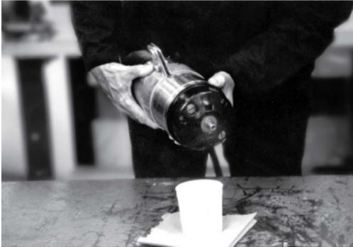
4. Wenn Flüssigkeiten austreten, müssen die Dichtungen getauscht werden.
