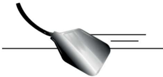
Geöffneter Schwimmerschalter = 0 im Statusdisplay (Schwimmerschalter ist abgefallen)
