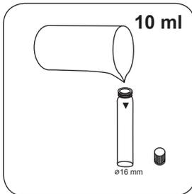
Eine **zweite Küvette** mit **10 ml Probe** füllen.
