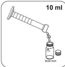
**10 ml Probe** in die Probenküvette geben.
