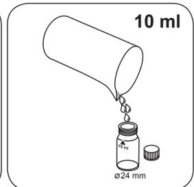
24-mm-Küvette mit **10 ml vorbereiteter Probe** füllen.
