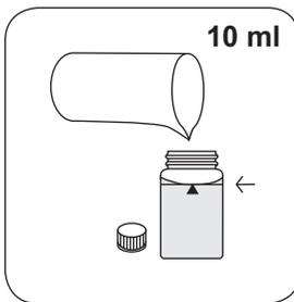
24 mm-Küvette mit **10 ml VE-Wasser** füllen.
