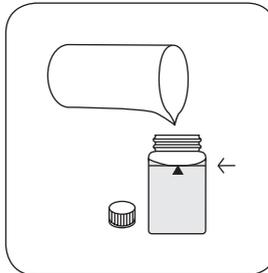
Küvette bis zur **10-ml-Marke** mit **VE-Wasser** auffüllen.
