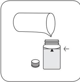
Küvette bis zur **10-ml-Marke** Küvette(n) verschließen.
