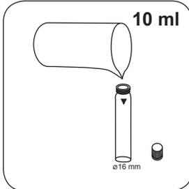
16-mm-Küvette mit **10 ml Probe** füllen.
