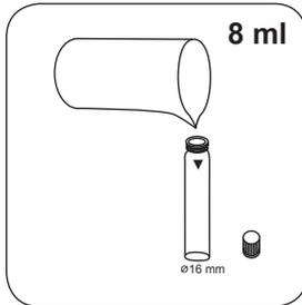
16-mm-Küvette mit **8 ml Probe** füllen.
