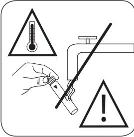
Die Küvette auf dem Kopf stehen für 1 Stunde abkühlen lassen. **Nicht mit Wasser abkühlen!** Nach dem Abkühlen umdrehen und **innerhalb von 10 min** im Photometer messen.
