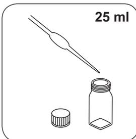
In ein Aufschlussgefäß **25 ml vorbereitete Probe** füllen.
