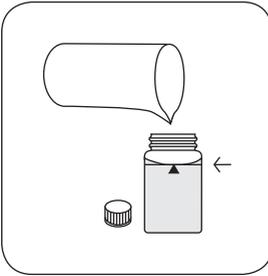
Küvette bis zur **10-ml-Marke** Küvette(n) verschließen.
