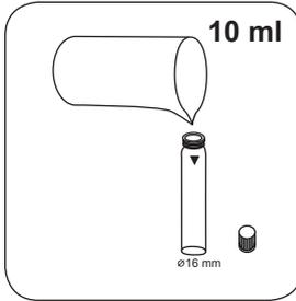
16-mm-Küvette mit **10 ml Probe** füllen.
