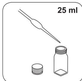
Das Aufschlussgefäß mit **25 ml** Probe füllen.
