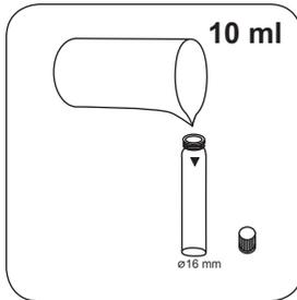
16-mm-Küvette mit **10 ml Probe** füllen.
