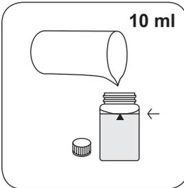
24-mm-Küvette mit **10 ml Probe** füllen.
