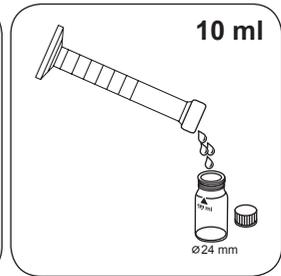
**10 ml Probe** in die Probenkuvette geben.
