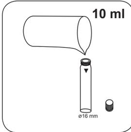
16-mm-Küvette mit **10 ml Probe** füllen.
