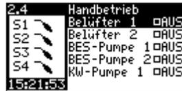
Der Hand-Modus ermöglicht es Ihnen, alle Aggregate, den Alarmkontakt und die Schwimmerschalter zu testen.
