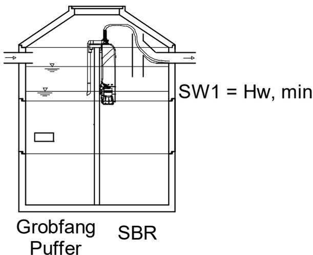
Das Abwasser durchläuft den Grobfang/Schlamm-speicher, in dem Primär- und ggf. Sekundärschlamm zurückgehalten bzw. gespeichert werden. Ein Teil des Volumens wird als Puffer genutzt.
