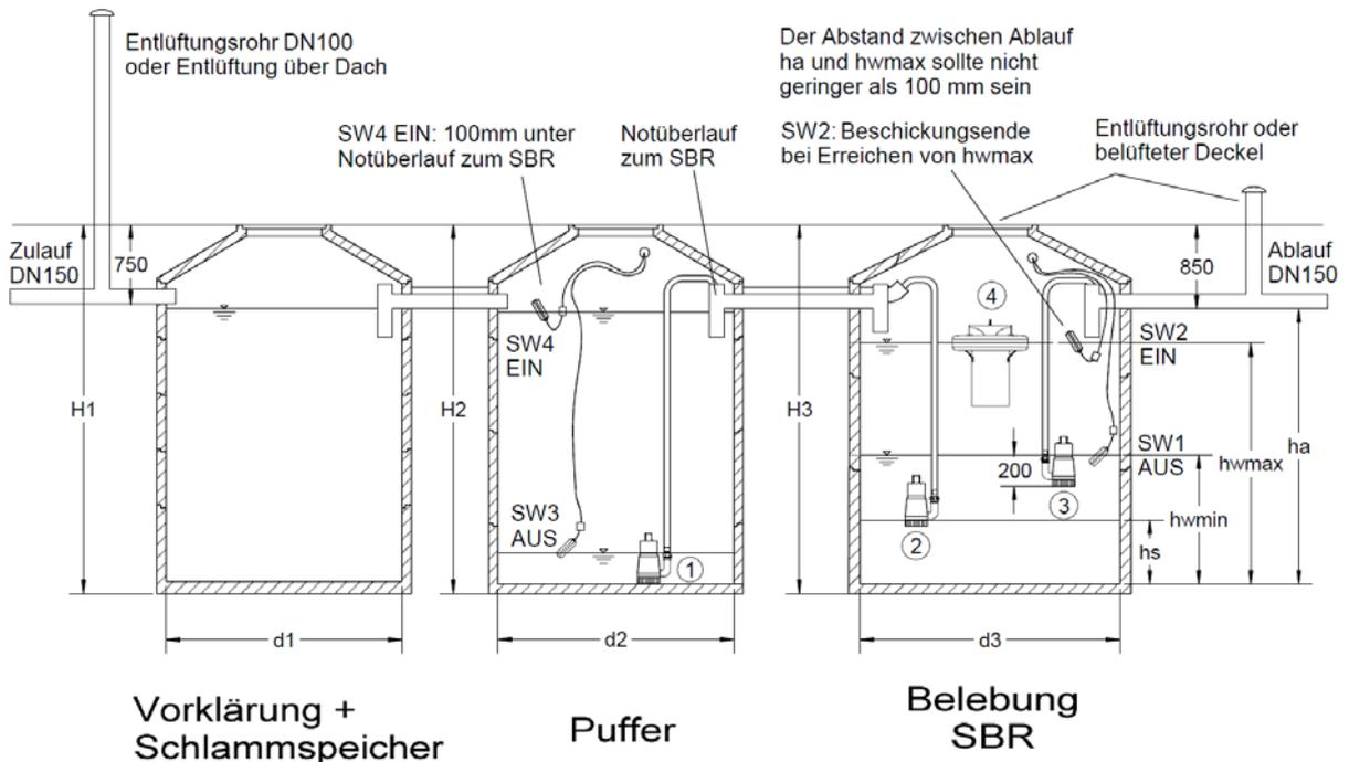
Das Abwasser durchläuft den Behälter für Vorklärung und Schlamm-speicher, in dem Primär- und Sekundärschlamm zurückgehalten bzw. gespeichert werden und gelangt im Freigefälle bis in das Pufferbecken.
