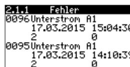
Aufzeichnung der aufgetretenen Fehlermeldungen. Eine Erklärung der angezeigten Meldungen entnehmen Sie bitte dem Anhang. Darstellung: Unterstrom A1 → Ausgang für Belüfter 1
