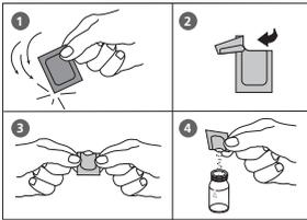
5. In die 10-ml-Probe den Inhalt **eines VARIO Phosphate Rgt. F10 Pulverpäckchens** direkt aus der Folie zugeben.
