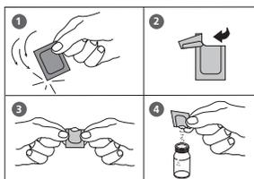
5. In die 10-ml-Probe den Inhalt **eines Chlorine TOTAL-DPD/ F10 Pulverpäckchens** direkt aus der Folie zugeben.
