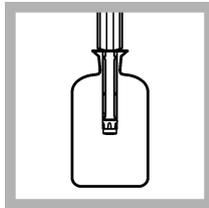
7. Nehmen Sie den Stopfen ab. Trocknen Sie die Sondenkappe sorgfältig mit einem nicht scheuernden Tuch. Setzen Sie die Sonde in die Flasche ein.
