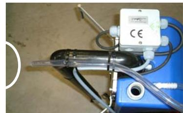
2. Anbringen einer Schelle zur Stabilisierung des Tanks beim Abpumpen
