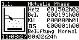
Die Statusanzeige informiert Sie über den aktuellen Zustand der Kläranlage. Angezeigt werden die Uhrzeit, die einzelnen Betriebsstunden, aktuelle Zyklusphase sowie die Restzeit der jeweiligen Phase. Im Störfall wechselt die Restzeitanzeige mit der Störungsmeldung.
