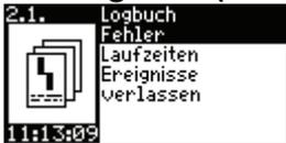
Im Logbuch werden alle relevanten Fehler, Laufzeiten, Ereignisse und hinterlegt. Sie gelangen zu den einzelnen Punkten mit  $\uparrow\downarrow$  und *OK*.
