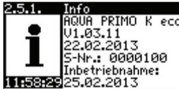
Angezeigt werden die gewählte EW-Zahl, die Software-Version (hier Testversion), Softwaredatum, Uhrzeit und Seriennummer des McWater®.
