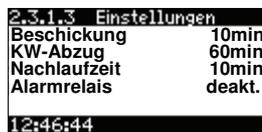
Änderung der Beschickungsdauer, der maximalen Klarwasserabzugszeit, der Nachlaufzeit sowie De-/Aktivierung des Alarmrelais.
