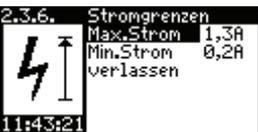
Die Stromgrenzen legen den Bereich der „normalen“ Stromaufnahme des Verdichters fest. Werden Stromaufnahmen gemessen, die unter bzw. oberhalb der festgelegten Werte liegen, wird eine entsprechende Alarmmeldung ausgegeben.
