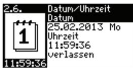
Einstellmöglichkeit für Datum (Anzeige = TT.MM.JJ) und Uhrzeit (Anzeige = HH:MM:SS)
