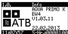
Es folgt der Wechsel zur Infoanzeige. Angezeigt werden die gewählte EW-Zahl, die Software-Version, Uhrzeit und Seriennummer des McWater®.
