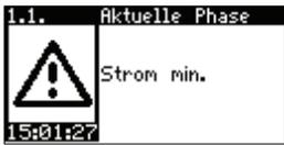
Tritt im laufenden Betrieb ein Fehler auf, wird dieser optisch (Display / rote LED) und akustisch angezeigt (+ ggf. Einrichtung am potentialfreien Kontakt). Durch Drücken der OK-Taste quittieren Sie die akustische Meldung (+ ggf. Einrichtung am potentialfreien Kontakt). Eine Fehlermeldung erfolgt im Display weiterhin im Wechsel mit der
