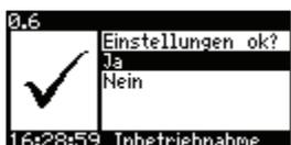
Haben Sie eine fehlerhafte Eingabe getätigt? Durch Auswahl von *Nein* und *OK* kann die Inbetriebnahme wiederholt werden. Sind die Eingaben korrekt, bestätigen Sie mit *Ja* und *OK*.
