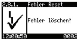
Eine Fehlermeldung im Display wird erst nach einem Fehler-Reset (d.h. nach Drücken von OK) gelöscht.
