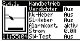
Hier haben Sie die Möglichkeit den Verdichter, die Mammutheber, den potentialfreien Kontakt und den Schwimmerschalter im Handbetrieb zu testen. Es werden der aktuelle Stand des Schwimmerschalters und die aktuelle Stromaufnahme angezeigt. Nach 15 Minuten erfolgt ein automatischer Rücksprung in den Automatikbetrieb.
