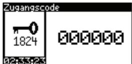
Durch die Eingabe eines Zugangscode ist sichergestellt, dass die Inbetriebnahme von einem Fachmann ausgeführt wird. Geben Sie die 6-stellige Code-Nummer mit *OK* und  $\uparrow\downarrow$  ein und bestätigen Sie mit *OK*.
