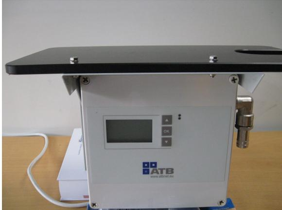
Auflageplatte mit Gewindeschrauben und Sicherungsmuttern auf der Standardkonsole befestigen (Ausschnitt für den Kompressorschlauch = rechts).
