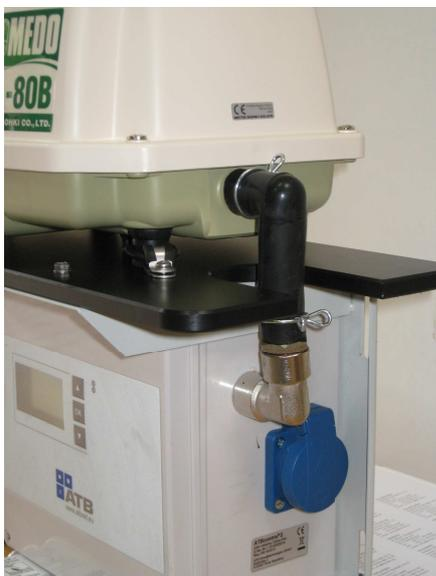
Der Kompressor kann anschließend in die O-Ring Halterungen eingesetzt und angeschlossen werden.
