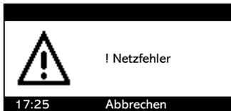
Bei Netzausfall, wird nach etwa 10 sec ein akustischer Alarm ausgelöst und es erscheint das links gezeigte Bild auf dem Display. Die Steuerung kann aus diesem Zustand mit längerem drücken der OK-Taste heruntergefahren werden. Bei Spannungswiederkehr geht die Steuerung automatisch wieder in Betrieb. Netzfehler und Netz OK werden im Logbuch protokolliert.
