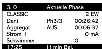
Tritt im laufenden Betrieb ein Fehler auf, so wird dieser optisch als Display-Meldung (siehe links „! I min Bel.“) und zusätzlich über die rote LED und auch akustisch durch einen Signalton gemeldet. Wird die Fehler-Meldung durch Drücken einer beliebigen Taste quittiert, erlischt das akustische Signal und die links gezeigte Display-Meldung.
