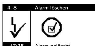
Alarmmeldungen werden auch nach dem Quittieren noch über die rote Fehler LED und über eine Meldung in der untersten Zeile im Display „Aktuelle Phase“ als aktiv angezeigt. Das Löschen des Alarms geschieht über den Punkt 4.8 Alarm löschen oder über die Aktivierung des Handbetriebs.
