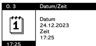
Geben Sie das aktuelle Datum und die Uhrzeit ein. Achtung, das Datum für die Erstinbetriebnahme kann nachträglich nicht mehr geändert werden. Datum und Uhrzeit sind wichtig für die korrekten Einträge im Logbuch und den automatischen Winterbetrieb!
